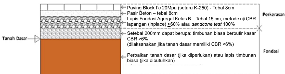
Gambar I-6 Potongan Lapis Perkerasan Paving block Jika Nilai CBR Tanah Dasar atau Tanah Asli < 6%
